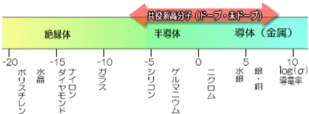
図1. いろいろな物質の導電率（辻野貴志「ナノエレクトロニクス.jp」）
